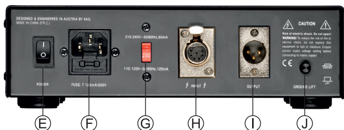
Figura 2: Mandos, entradas y salidas en la parte trasera de la unidad de control remoto
