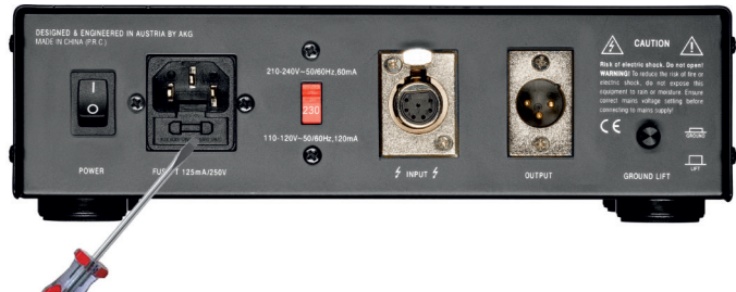
Figure 4: Ouverture du compartiment des fusibles
