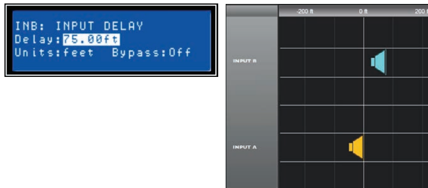
Abbildung 5.1: Als Delay für Eingang B wurde ein Wert von 75 Fuß (ca. 23 Meter) eingestellt. In der Darstellung befindet sich das Lautsprecher-Array B 75 Fuß vor dem Hauptlautsprecher-Array A. Der Einfluss der Lufttemperatur wird bei der Berechnung der Gesamtverzögerungszeit automatisch berücksichtigt. Die entsprechende Einstellung des Temperaturwerts nehmen Sie im Setup-Menü vor.
