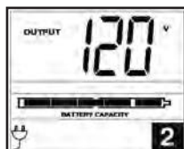
2. Tension de sortie
