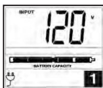
1. Voltaje de Entrada
