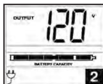
2. Tension de sortie
