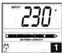
1. Voltaje de Entrada
