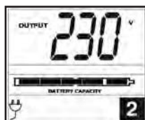
2. Tension de sortie
