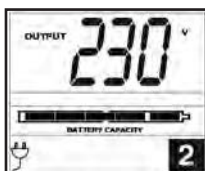
2. Tension de sortie
