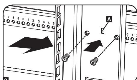
La même méthode permet d'ajuster la profondeur des 2 profilés pour les chemins de câbles.
