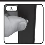
**STEP 2:** Disengage position pin.
