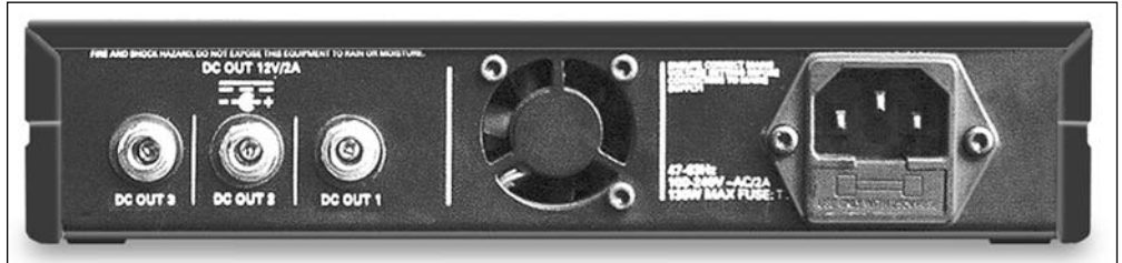
Fig. 2 : Entrées et sorties en face arrière
