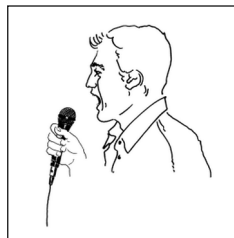
Fig. 1: Posición típica del micrófono
