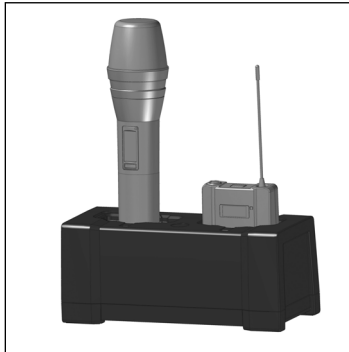
Sender in die Ladestation einsetzen
