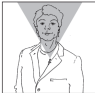
Fig. 4: Ángulo de toma del micrófono
