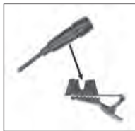
Fig. 2 : Fixation du micro au clip
