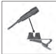
Fig. 2: Fijación del micrófono en el clip
