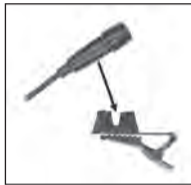
Fig. 2: Fissare il microfono sulla clip di fissaggio
