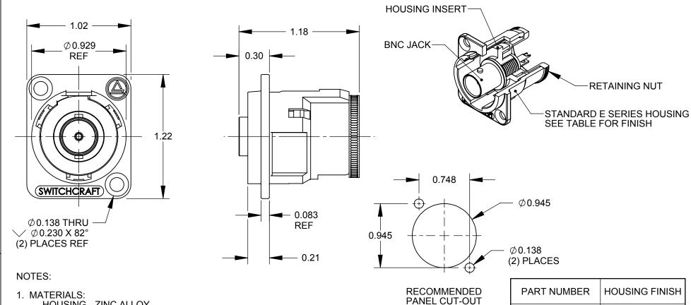
HOUSING - ZINC ALLOY HOUSING INSERT - THERMOPLASTIC, BLACK RETAINING NUT - COPPER ALLOY, NICKEL PLATED BNC JACK - COPPER ALLOY, NICKEL PLATED
