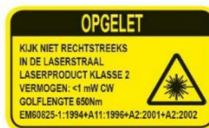
Zichtbare laserstraal. Kijk niet in de laserstraal om oogletsets te voorkomen. Dit toestel is een laserproduct klasse 2. Uitgangsvermogen < 1 mW, golflengte 650 nm.
