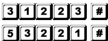
De duress-uitgang wordt geactiveerd (uitgang schakelt naar aarding) en uitgang 1 wordt geactiveerd voor 1 seconde
