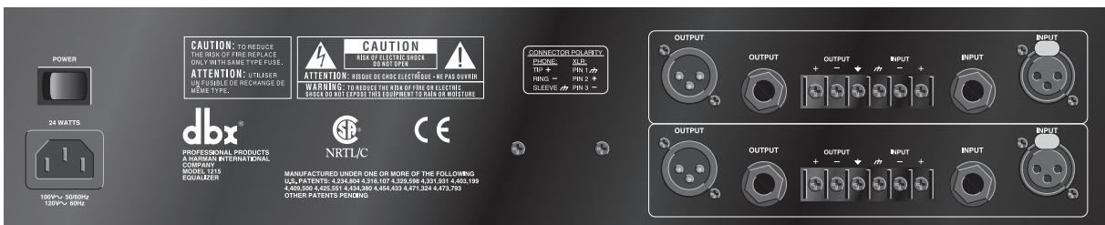
**POWER-Schalter:** Schaltet das Gerät ein und aus. Unternehmen Sie die Audio-Verbbindungen immer, wenn das Gerät ausgeschaltet ist.
