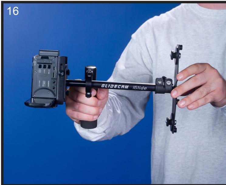
NOTE: LATER AFTER YOU ADJUST THE VERTICAL BALANCE OF THE iGlide YOU WILL HAVE TO GO BACK AND READJUST THE HORIZONTAL BALANCE AGAIN IN ORDER TO OBTAIN A FINE BALANCE OF THE WHOLE SYSTEM.
