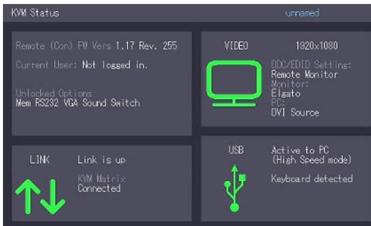
Im "Status Menü" wird der aktuelle Stand der Extenderverbindung angezeigt. Das Menü zeigt die Informationen über die Verbindung, die Auflösung des Videokanals und den USB Status an. Die aktivierten Upgrades und die aktuelle FW-version werden in der linken oberen Ecke angezeigt.
