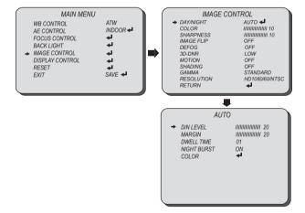
Select IMAGE CONTROL using the UP or DOWN button. You can select DAY/NIGHT using the UP or DOWN button.
